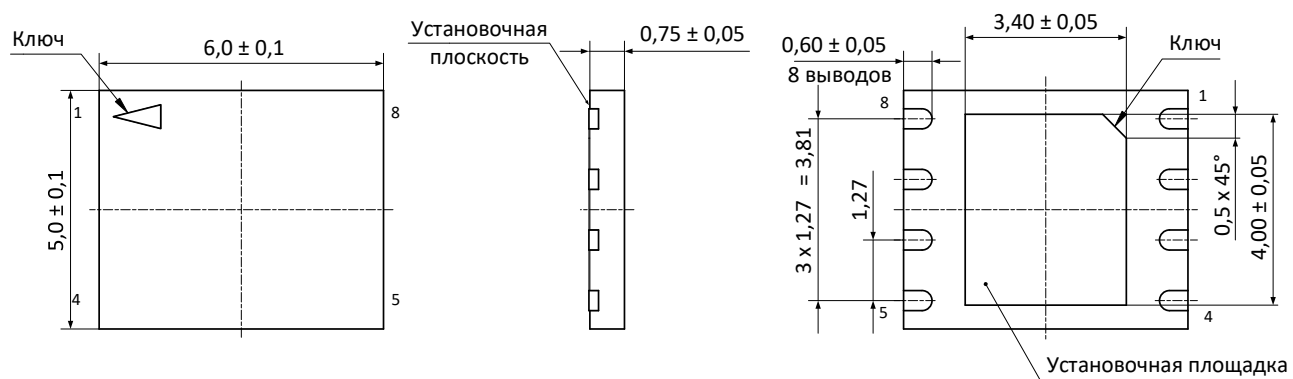
Рисунок 4 – Микросхема в корпусе DFN8 5×6×0,75 (1,27)
